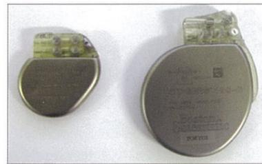
写真上 ペースメーカーと、植え込み型除細動器。除細動器の方が一回り大きいです。写真右 除細動器とリード。
